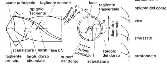
$\sigma$  = Angolo del vertice (sigma)       $\Psi$  = Angolo del tagliente trasversale (Psi)
