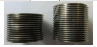
Osservando questi due inserti filettati si potrebbe pensare che ci sia stato un errore sulla lunghezza degli inserti, in quanto l'inserto G1" è decisamente più corto rispetto al suo diametro. Infatti, una volta installati, entrambi gli inserti filettati hanno una lunghezza di 1,5 volte la lunghezza del diametro nominale a (=1,5D); compresa la riserva di sicurezza.
